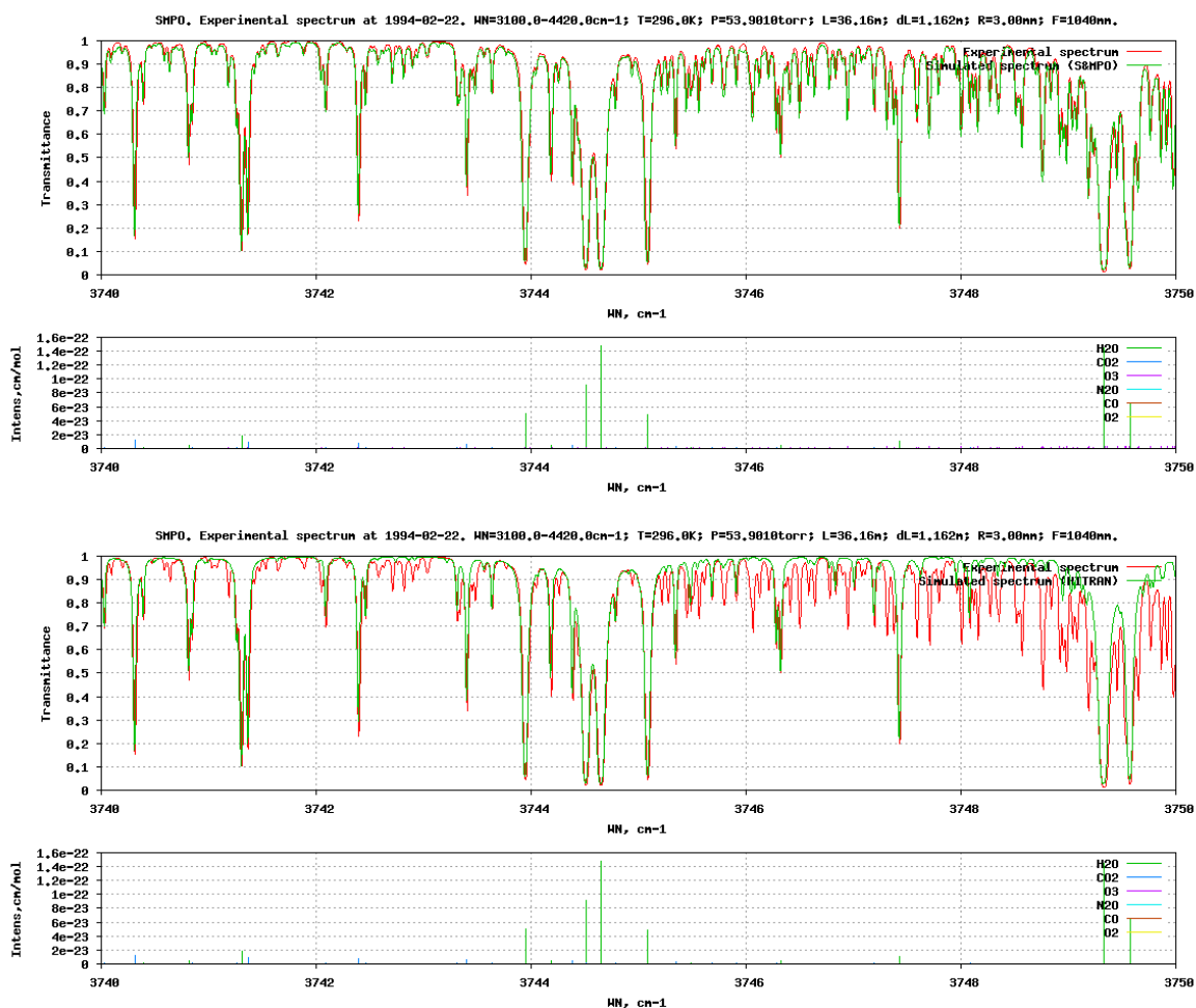
Рисунок 2. Сравнение экспериментального спектра поглощения молекулы ^{16}\text{O}_3 (красный цвет) с расчётным (зелёный цвет) около 3745\text{ cm}^{-1} по данным S&MPO (верхняя панель) и HITRAN-2012 (нижняя панель)
